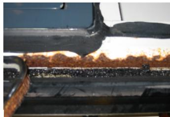
Corrosion du chaudière
