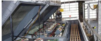
Equipement électrique sur le toit (entre autres : 4 Quadranten-Steller, Convertisseur embarqué)
