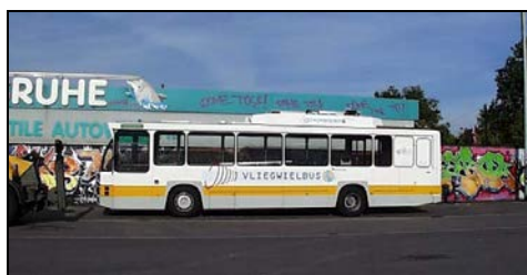
Bus à récupérateur d'énergie par volant d'énergie CCM
